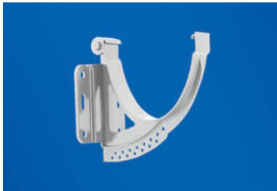
Кронштейн применяется для крепления желобов к вертикальной лобовой доске. Кронштейны необходимо устанавливать на расстоянии 60 см друг от друга. Кронштейн можно использовать как самостоятельный элемент крепления, так и вместе с поворотным элементом кронштейна (см. ниже.)
