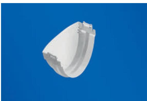
Заглушка желоба применяется для герметизации конечных участков водосточной системы. Заглушка в отличие от желоба имеет симметричную форму, что позволяет использовать её на любом торце. По краям заглушки располагаются крепежные защелки, которые позволяют герметично зафиксировать заглушку на конечном участке водосточной системы, с помощью использования специальных клипс (см.ниже).
