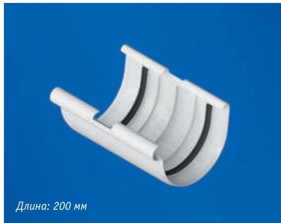
Предназначена для соединения отдельных желобов в единую систему. На внутренней стороне муфты имеются специальные ограничители с надписью «STOP», которые специально ограничивают ту зону, в пределах которой нельзя соединять элементы. Это объясняется тем, что в процессе эксплуатации водостоков возможны линейные расширения. При плотной состыковке происходит изменение формы водосточной системы, поэтому необходимо оставлять зазор в 2-3 см между желобами.
