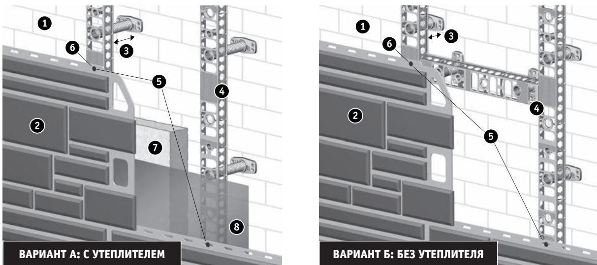
1 – стена дома, 2 – фасадная панель, 3 – вентилируемый зазор, 4 – плоский широкий профиль обрешетки (тип А или В), 5 – саморезы, 6 – технологическое отверстие, 7 – утеплитель, 8 – ветро-влагозащитная мембрана (Альта-Спан А)
